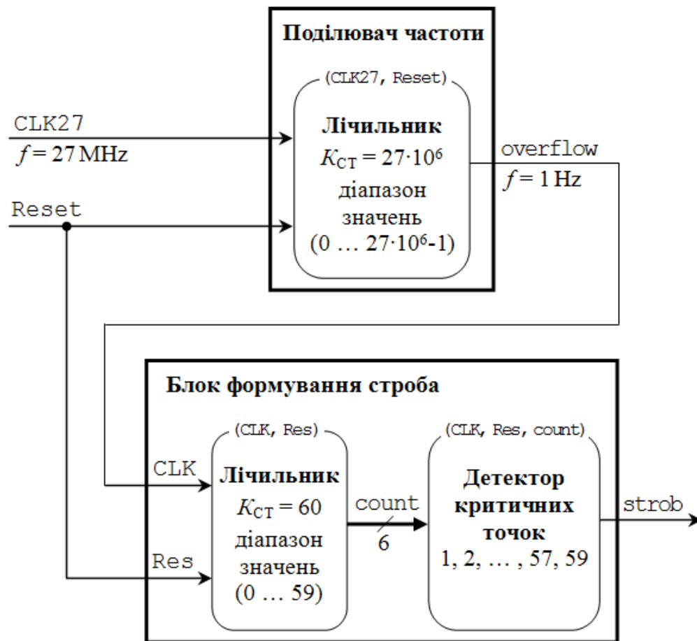
Рис. 2. Діаграма потоку даних генератора строба
